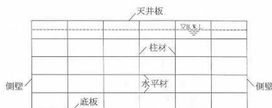
図-1 矩形ステンレス鋼製配水池における内部の補強架構（ラーメン構造）
