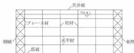
図-2 矩形ステンレス鋼製配水池における内部の補強架構（プレース付き構造）
