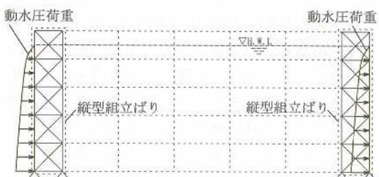
図-3 ブレース付き架構の耐震計算モデル
