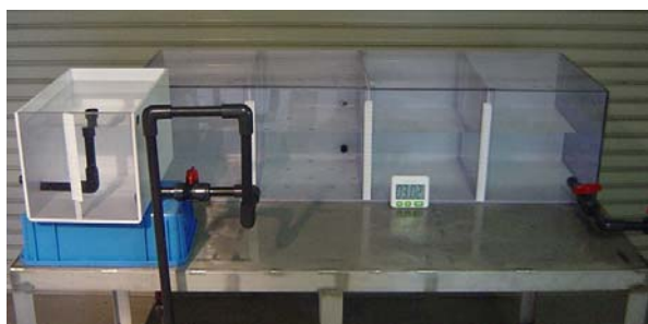
図1 実験用の縮小水理模型
