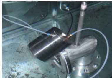
図2 フロート式緊急遮断弁の実験状況
